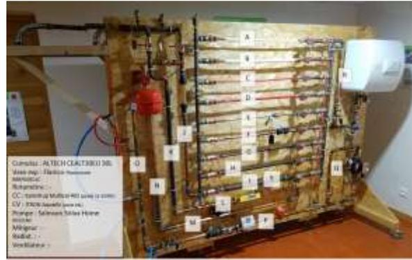
Banc d'essai hydraulique d'Enertech pour la vérification et l'étalonnage des compteurs de chaleur.
