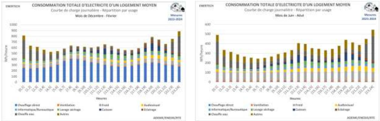
Figure 138 : Courbe de charge électrique d'un logement moyen français - Panel Elecdom année 5
